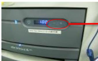
イルミネーターの+と-ボタンを同時に押すとランプ使用時間が表示される。
