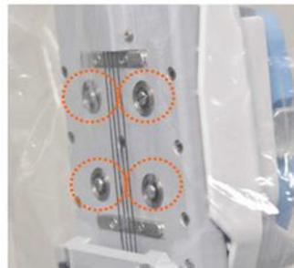
ステリルアダプタの背面にある4つのピンが突出していないことを確認する(フラットな状態でOK)
