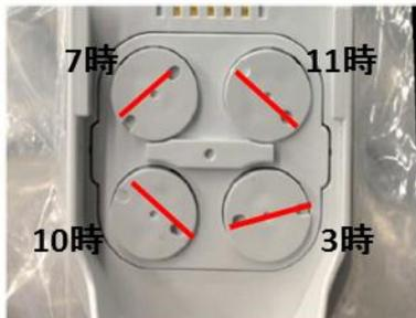
ディスク前面の穴の並びが上の写真のようになっていることを確認する(ダイヤ)
