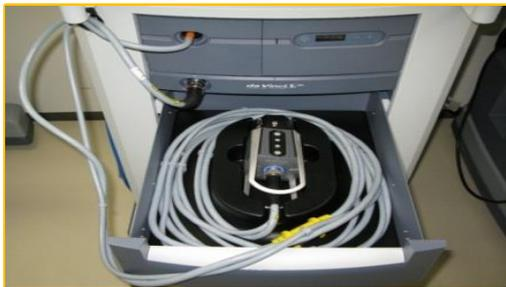
3Dカメラ及び光源装置も付属されており、術野映像の情報処理を行って高画質3D映像を映し出す事ができる。
